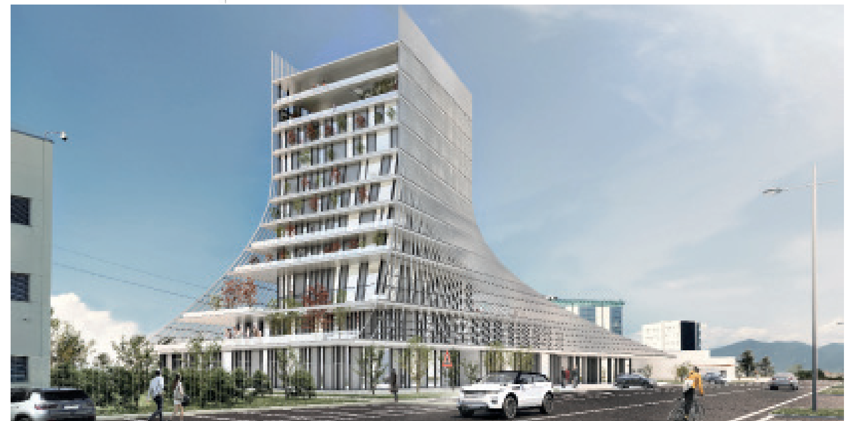
A nord e sud della Tower 3 Forti la vegetazione assume carattere architettonico, partecipando al disegno dei prospetti secondo le logiche della stagionalità delle essenze, mentre a est e ovest la rotazione dei piani diventa schermatura per la mitigazione dell'apporto solare e per l'individuazione degli accessi principali al progetto
